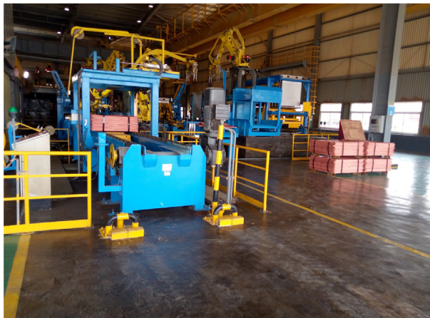
Production automatisée des cathodes de cuivre par des robots dans l'une des usines de la Sicomines.
