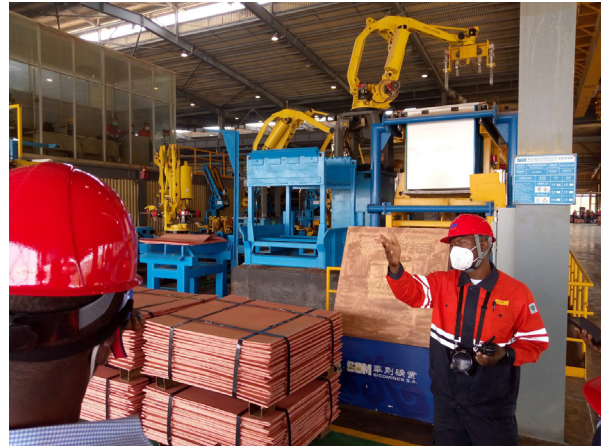
Production automatisée des cathodes de cuivre par des robots dans l'une des usines de la Sicomines.
